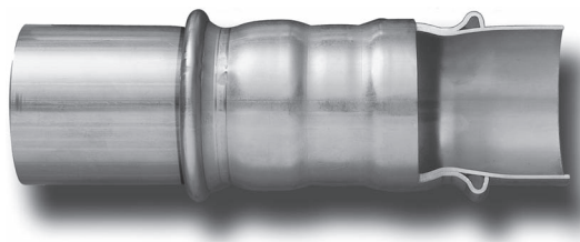
Графика 2: Пресс-соединение Mapress после прессования
